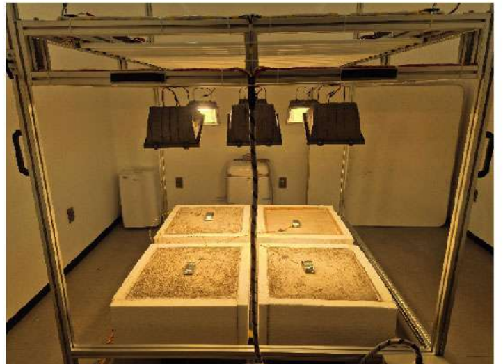
Figura 2: Módulos de prueba en la cámara de ambiente controlado con incidencia de radiación desde el simulador. Fuente autor (2025).
