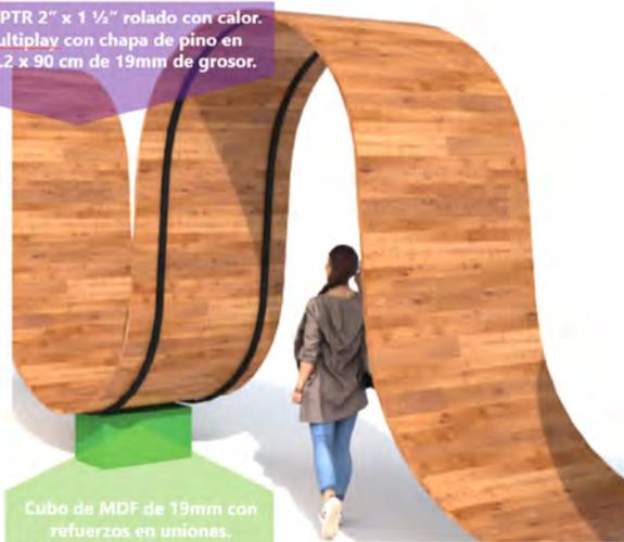
Cubo de MDF de 19mm con refuerzos en uniones. Acabado con pintura acrílica al alto brillo.
