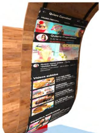
Estructura de bastidor con perfiles de aluminios forrados de Durok, terminados con basecoat. Forro de Vinil autoadherible impreso. Medidas 1.44 x .90 cm.
